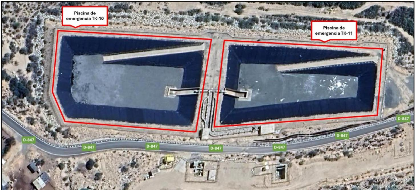
5. Estas instalaciones consisten en estructuras recubiertas con una geomembrana de HDPE<sup>1</sup> cuya finalidad es recibir descargas de relaves y aguas de proceso provenientes tanto del Sistema de Transporte de Relaves (STR) como del Sistema de Recirculación de Aguas (SRA), y funcionar excepcionalmente como una instalación de almacenamiento de reserva del material o contenido del concentrado o de agua, sin derivar en afectaciones en los componentes medioambientales.
